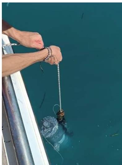
Figura 2: Prelievo di acqua tramite bottiglia Niskin da 10 l
