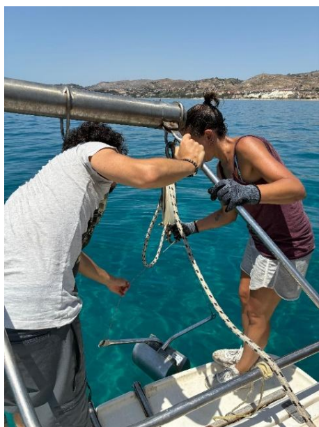
Figura 3: Campionamento del sedimento tramite benna Van Veen da 5 l
