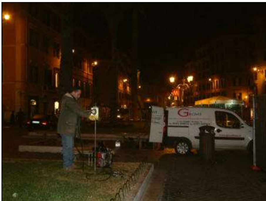
Foto 1. Esecuzione prova penetrometrica dinamica DPM1.
