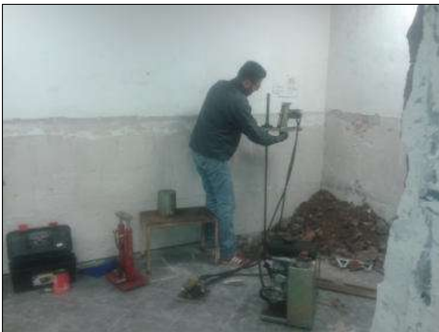
Foto 1. Esecuzione prova penetrometrica dinamica DPM1.
