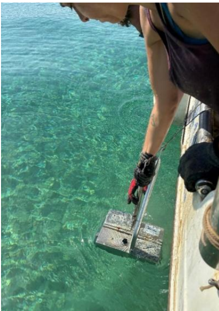
Figura 3: Campionamento del sedimento tramite benna Van Veen da 5 l
